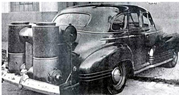
Figura 38 - Carro com aparelho de gasogênio
