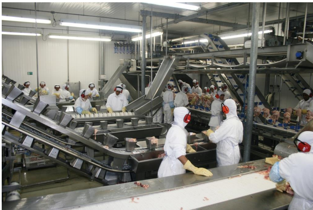
Figura 9 – Esteiras de pendura no cone, corte e transporte aéreo por calhas
